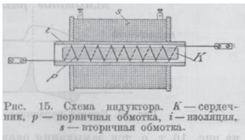
Рис. 15. Схема индуктора. К - сердечник, р - первичная обмотка, i - изоляция, s - вторичная обмотка
