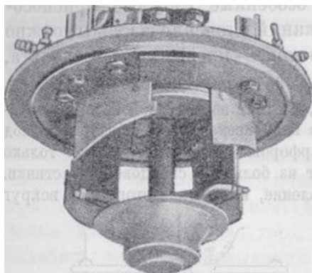
Рис. 18. Газовый прерыватель «Апекс» в открытом виде (сегменты и трубочки).
